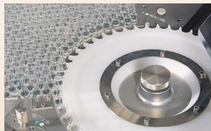
供給部：機械を停止させることなく供給を停止することで、強制排出本数を大幅に削減できます。
