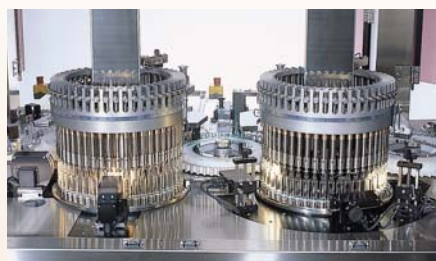
検査テーブル：外観検査テーブルを追加したことで、各種検査に対応することができます。
